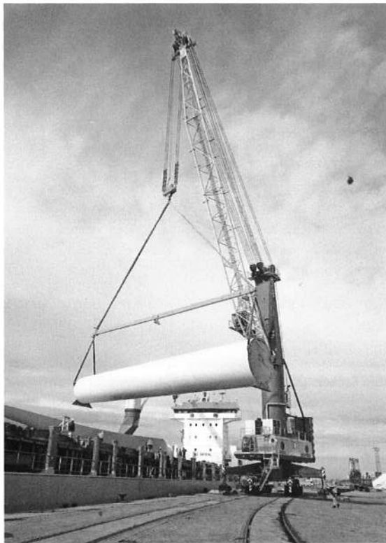
Verladung eines der fünf Turmsegmente mit dem Mobilkran
