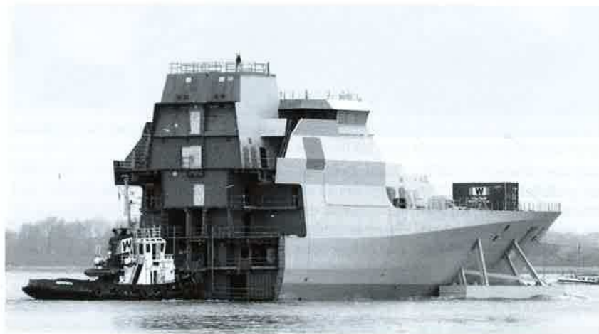
Von der Bremer Lürssen Werft wurde die Bugsektion zu Blohm + Voss geschleppt
