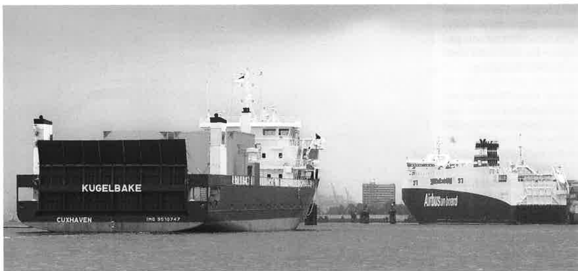
Die 79,30 Meter lange und 18,60 Meter breite „Kugelbake“ wurde speziell für den Transport von Airbus-Flugzeugteilen konzipiert
