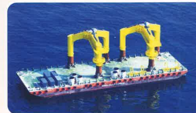
Die in Cuxhaven gefertigten Tripiles transportiert das Unternehmen zeitnah in den Windpark. Insgesamt 80 Gründungsstrukturen werden in Cuxhaven gebaut.
