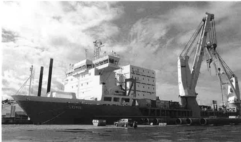
Der SAL-Schwergutfrachter „Lone“ bei der Verladung der 38 Meter langen Testpfähle
