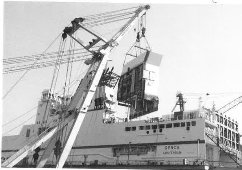
In Bremerhaven erfolgte jetzt der Einbau eines Scrubbers auf dem Mehrzweckfrachter „Genca“
