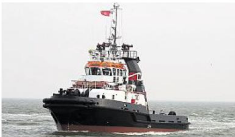
„Wulf 7“: Baujahr 1998, 30 m lang, 4,40 m Tiefgang, 13,5 Knoten schnell, 50 Tonnen Zugleistung, zwei Maschinen à 1820 kW auf Schottelantrieb.
