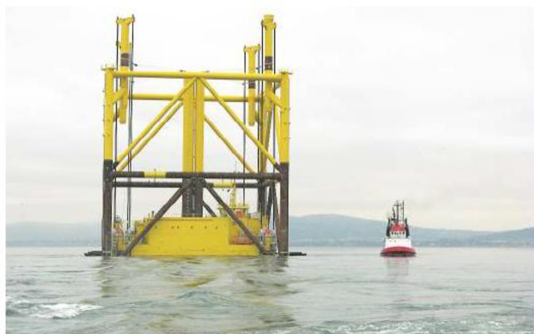
Eines der Fotos aus dem Vortrag zeigt das Größenverhältnis zwischen dem Schlepper „Wulf 4“ und der zu verschleppenden Wohn- und Trafoplattform für den ersten BARD-Windpark.
