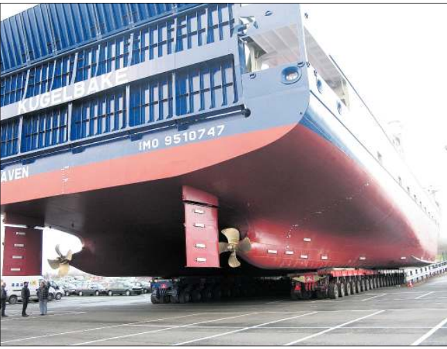
Spektakulärer „Stapelauflauf“ Ende Dezember beim Stahlbaubetrieb BVT in Bremen. Einige Hundert Meter bis zur Kaikante werden auf dem Landweg zurückgelegt...
