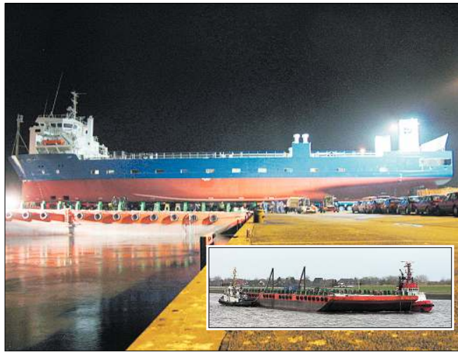
... bis das fertige Schiff auf den bereitliegenden Transportponton „TOW III“ ((kl.F.) gefahren wird. Wulf-Schlepper bringen den Neubau dann Huckepack nach Bremerhaven...
