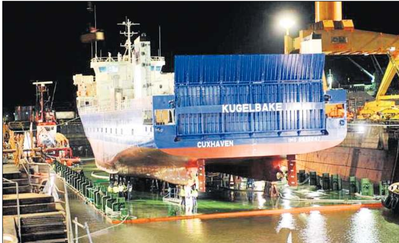
... wo der Ponton samt „Kugelbake“ durch Fluten der Tanks im Lloyd-Dock abgesenkt wird. Das Schiff treibt anschließend auf und wird später zum Endausbau und zum Justieren der Motorenanlage verholzt.
