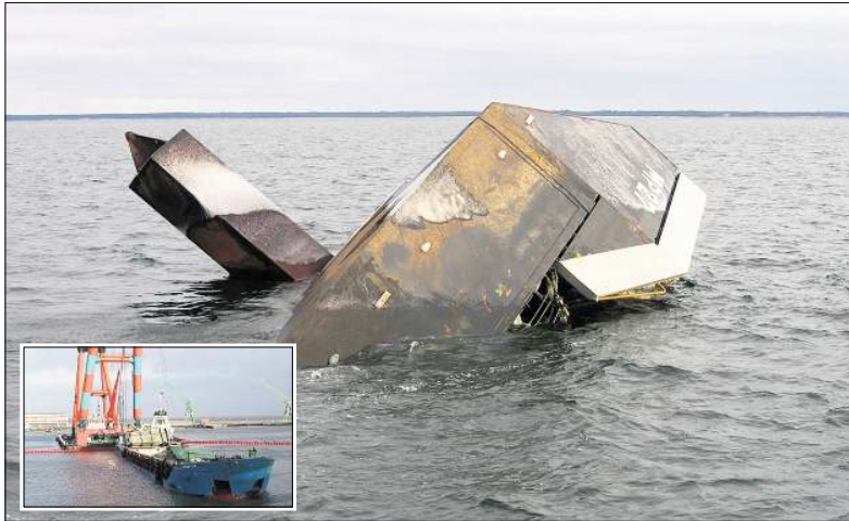
Die gesunkene Jackup-Plattform „MP 27“ nach der Kenterung. Deutlich zu erkennen: Eines der vier Beine, mit denen sich das Schiff am Grund positioniert. Wie damals bei der „Maritime Lady“ wird der Schwimmkran „Samson“ die Bergung übernehmen. Fotos: Wulf/Sassen
