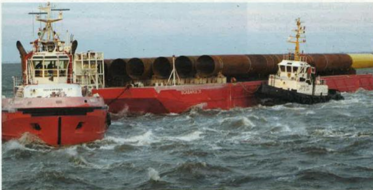
Otto-Wulf-Schlepper befördern Rammrohre für künftige Windparks auf hoher See.
